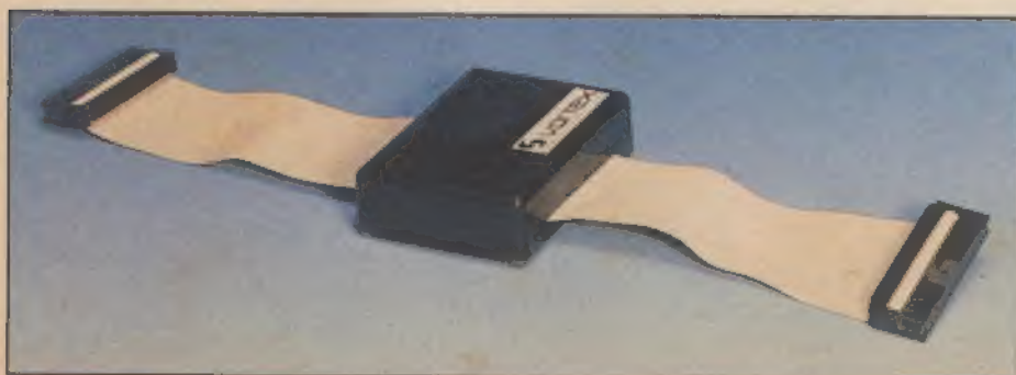
Ein Adapter erlaubt den Anschluß des Schneider-Laufwerks an die Diskettenstation von Vortex
